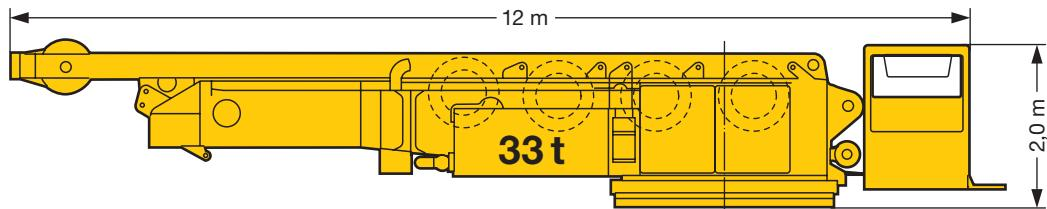
Drehbühne mit Winde IV inkl. Seil und Mittelteil ohne Quick Connection
