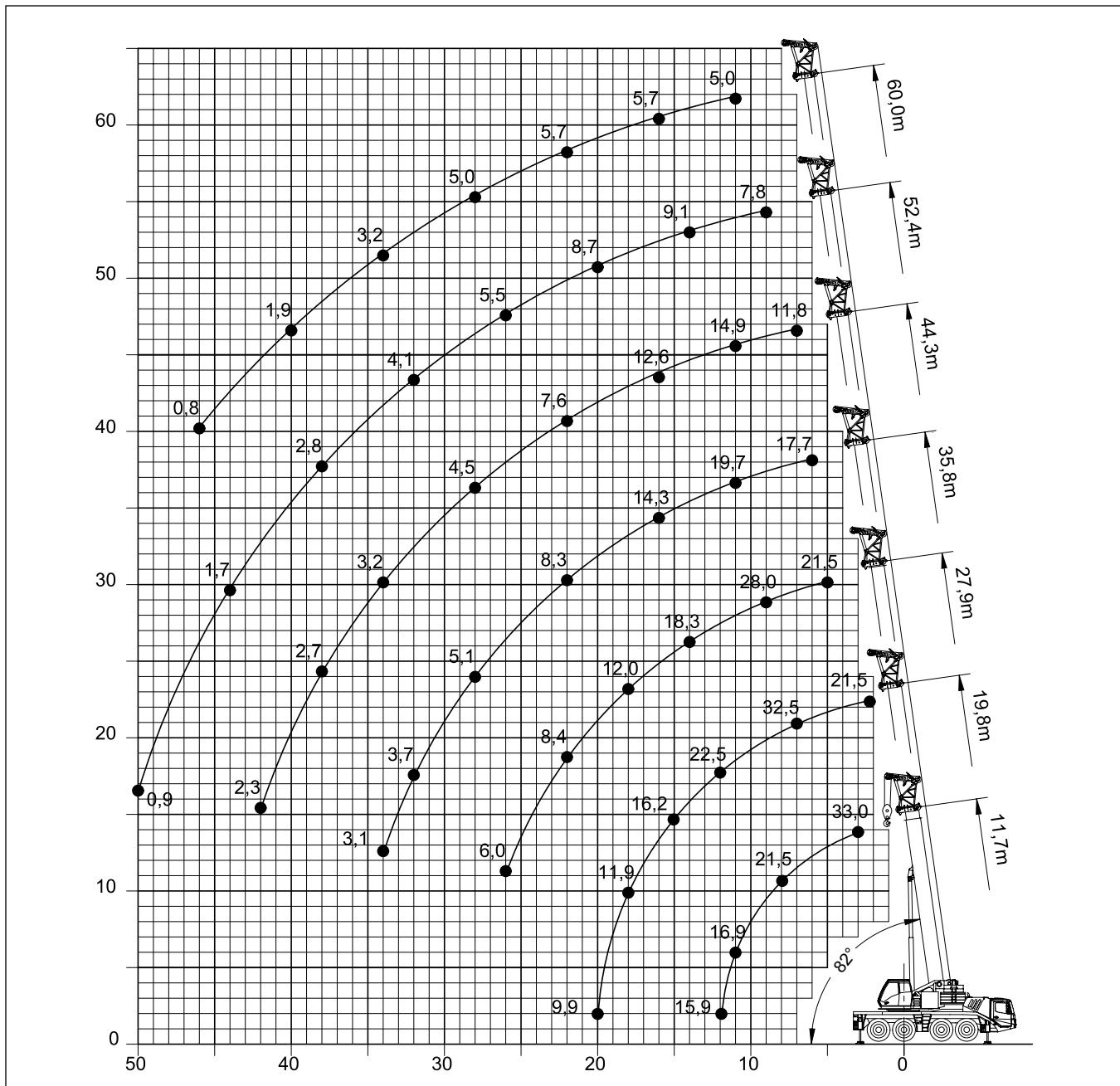
Load charts • Traglasten • Capacités de levage
